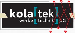
Legen Sie die klebende Seite nun wieder um und achten Sie darauf, dass die beiden Hälften des Klebestreifens genau aneinander passen. Danach streichen Sie mit einem Raker die Folie von innen nach außen fest. Das gleiche machen Sie mit der anderen Hälfte.
